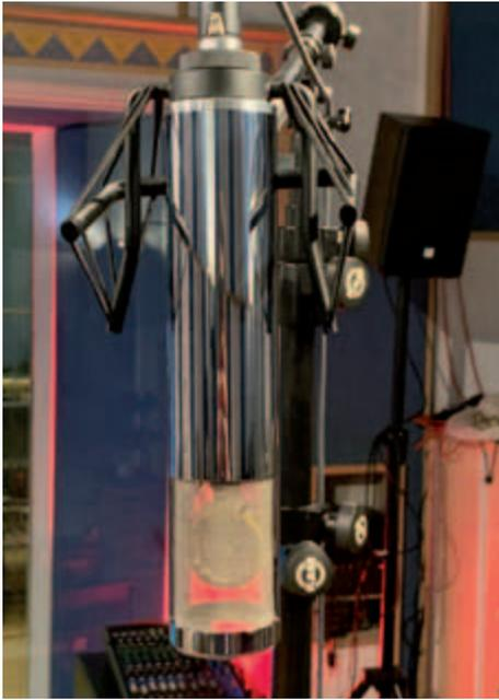
über einen verchromten Messing-Gehäusekörper mit einem Korb aus rostfreiem Edelstahl. Das Mikrofon ist eine überaus imposante Erscheinung, dessen Optik die Erwartungen an den Klang gleich höherschraubt. Als Röhre kommt eine E83F Pentode zum Einsatz, in Kombination mit
